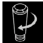
Naskrutkovať filter do nádoby na vodu
